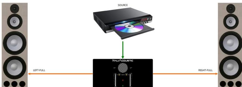
In questa modalità il finale si comporta come un classico amplificatore di tipo “dual mono” dove ogni ingresso viene amplificato separatamente e portato all’uscita relativa, per utilizzarlo con una coppia di diffusori pilotati singolarmente a banda intera (cosiddetto “monowiring”).
